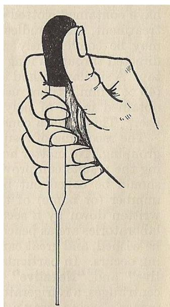
Fig.2: Holding a Pasteur pipette
