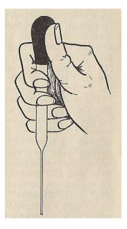
Fig.2: Holding a Pasteur pipette
